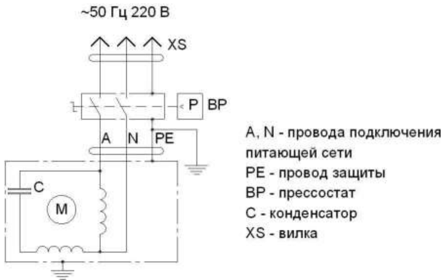
Рисунок А.1 - Схема электрическая принципиальная компрессоров СБ4/С-20.11047В, СБ4/С-24.11047В, СБ4/С-50.11047В, СБ4/С-20.11048В, СБ4/С-24.11048В, СБ4/С-50.11048В
