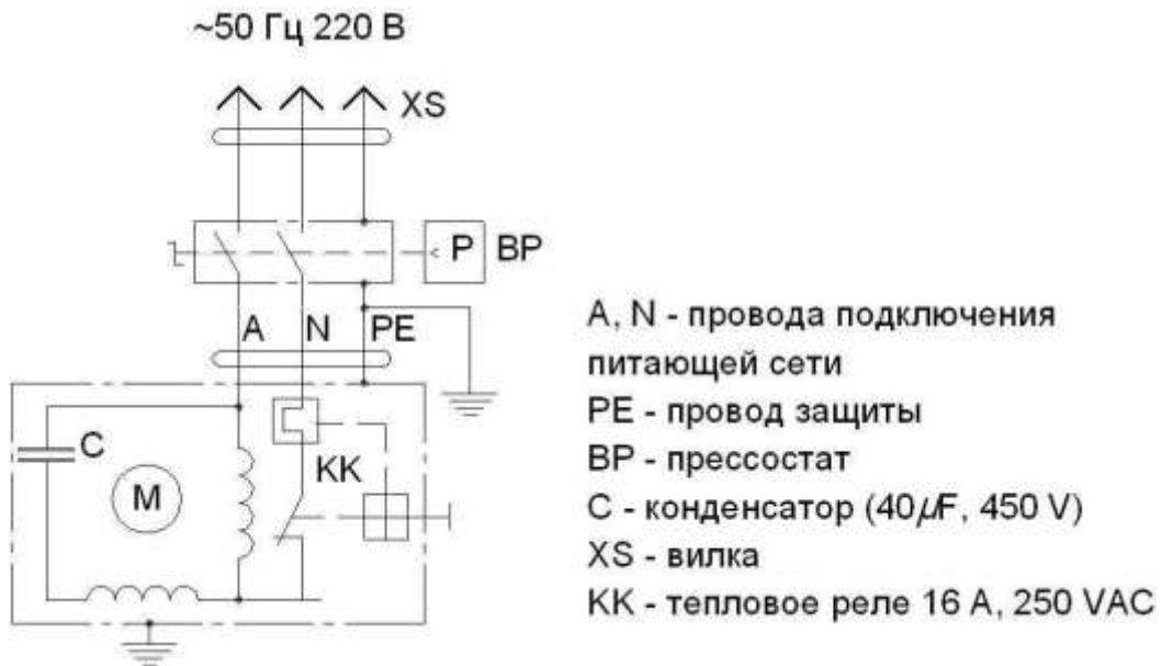
Рисунок А.2 - Схема электрическая принципиальная компрессоров СБ4/С-20.12047В, СБ4/С-50.12047В, СБ4/С-100.12047В, СБ4/С-100.12047ВВ
