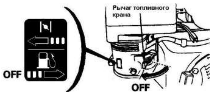
Рисунок 12 – Рычаг топливного крана в положении "OFF" ("Выключено")
